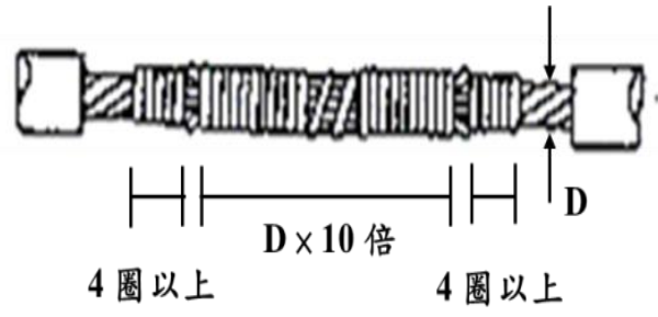
圖二四~四 絞線加紮線之延長連接法
